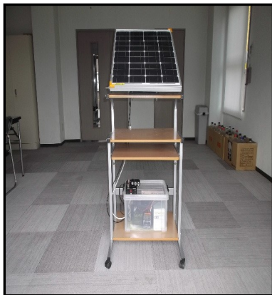
手動ですが太陽光に合わせて取り入れ角度・方向を調整できます。（使用例）
